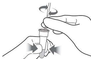
③ ボトルの首下をつまみ、滅菌綿棒から液体を搾り取るようにして滅菌綿棒を抜き取ります。
