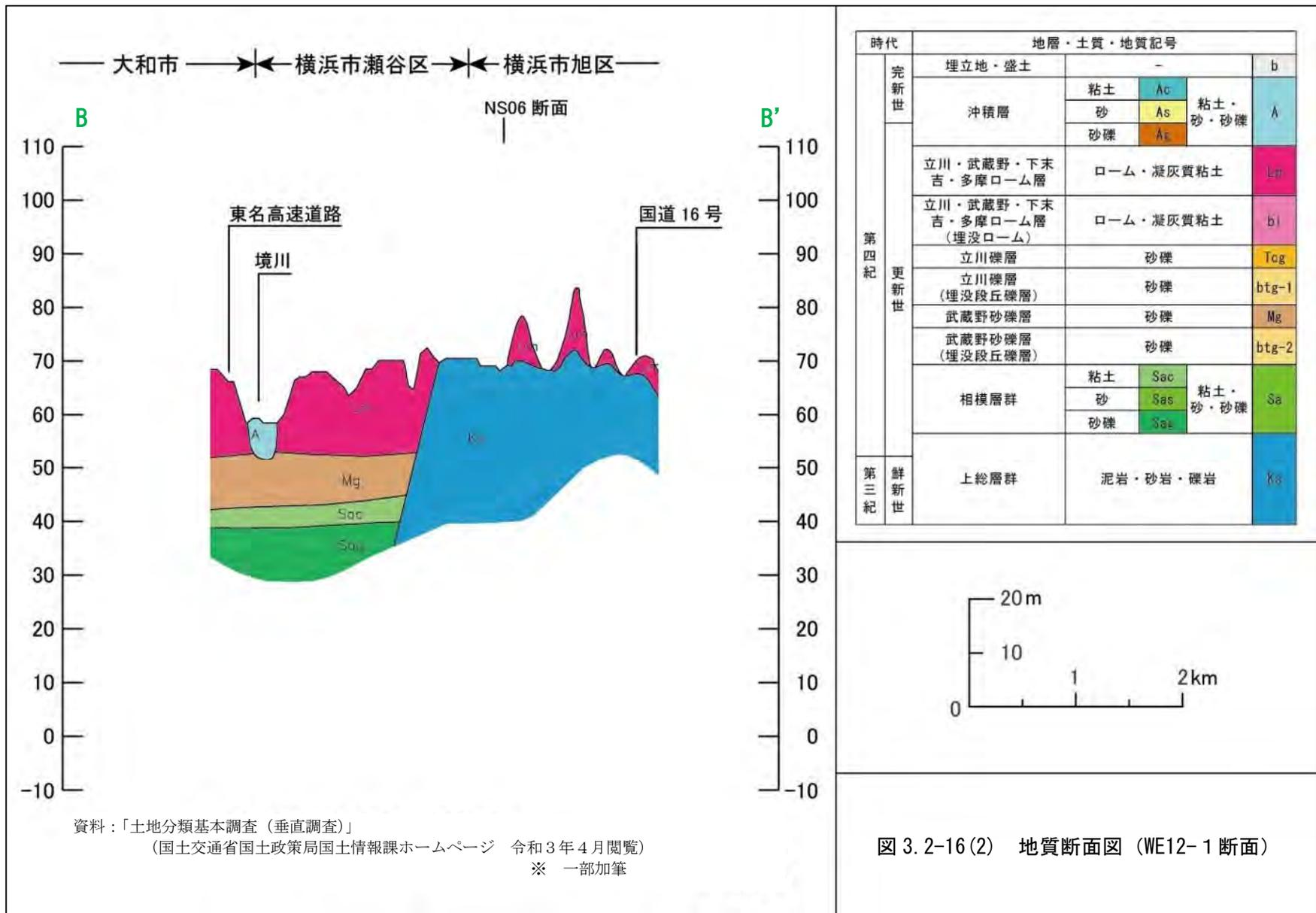
図 3.2-16(2) 地質断面図 (WE12-1 断面)
