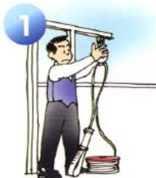
1 取付金具に調整器がしっかりと取り付けられているか確認します。
