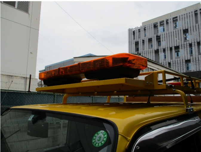
⑱ 散光式回転灯 ※地上高 2,300mm 以下とする (高さ制限道路通行のため)
