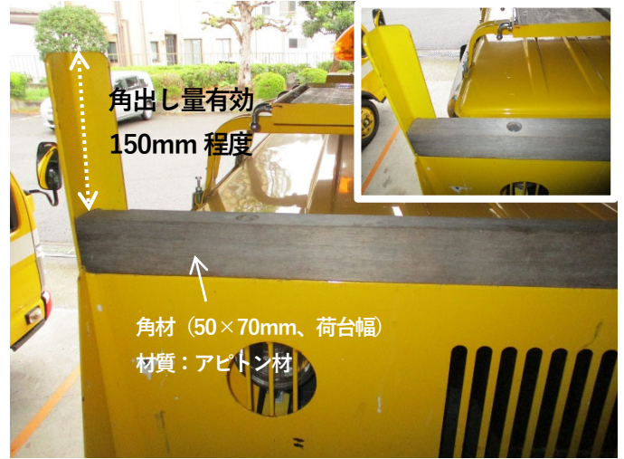
⑩ 鳥居部への角と角材設置 ※地上高 2,300mm 以下とする (高さ制限道路通行のため)
