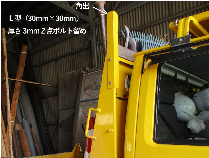
⑩ 鳥居部への角と角材設置 ※地上高 2,300mm 以下とする (高さ制限道路通行のため)
