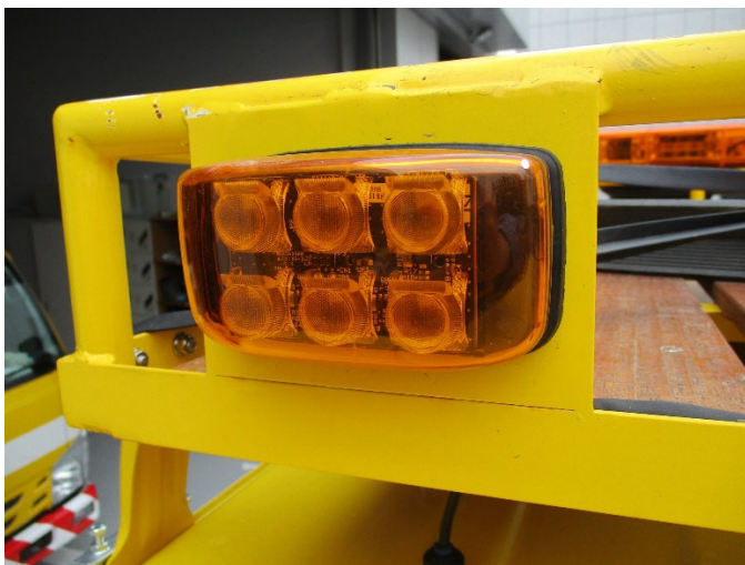
㉑ LED 黄色補助警告灯 ※ルーフデッキ部に取り付け
