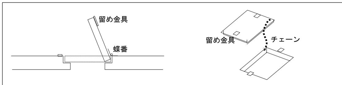
図5-6 脱落・飛散防止措置の例
