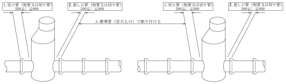
注) 3. の区間で延長調整のため切り管を使用した場合は、ゴム輪がなくなりますので下図に示すように止水性に配慮してください。
