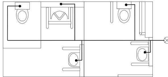
図 4-13-2 床下配管が多い配管例：×
