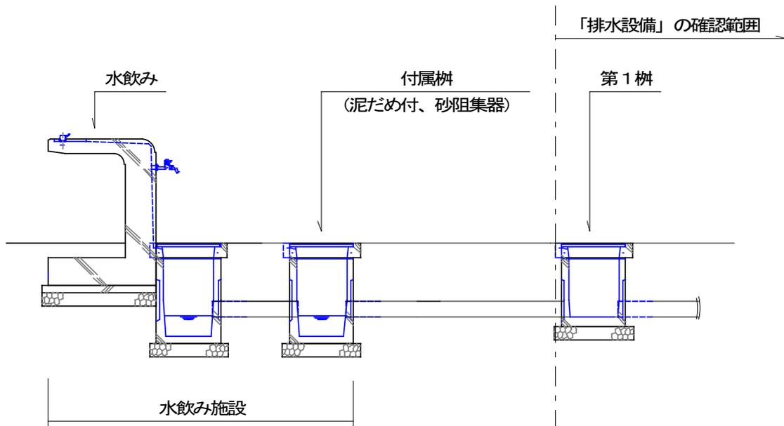
図 6-2 水飲みに付属する柵を泥だめ付きにした場合の排水設備の確認範囲の考え方
