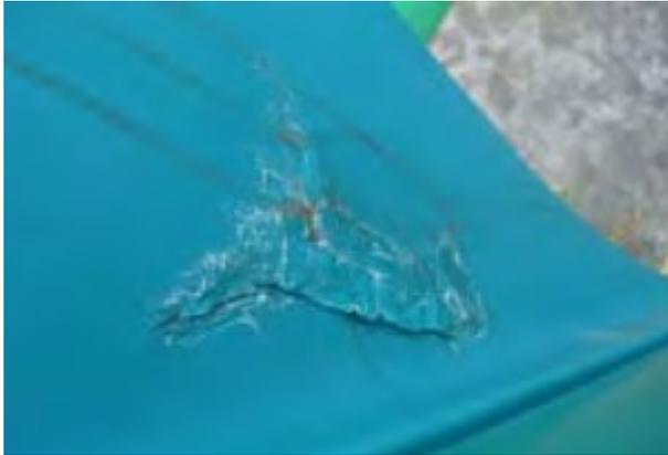
※FRP は FiberReinforcedPlastics (繊維強化プラスチック) の略称。ガラス繊維などの繊維をプラスチックに入れて強度を向上させた複合材料のこと。特に、ガラス繊維で強化して成形したものは、GFRP または GRP と呼ばれる。軽量・耐衝撃性が特徴だが、劣化により繊維質がささくれ状に出てくるため、危険である。
