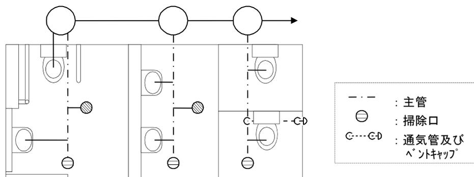
図 4-15 掃除口及び通気管の配置例
