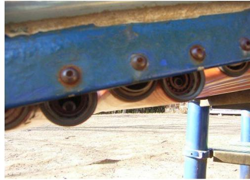
図 2-19 ローラー破損の例②
