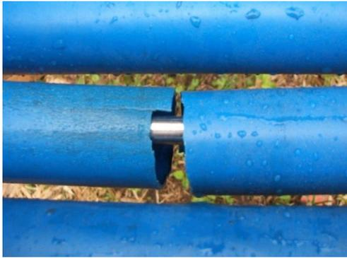
図 2-18 ローラー破損の例①
