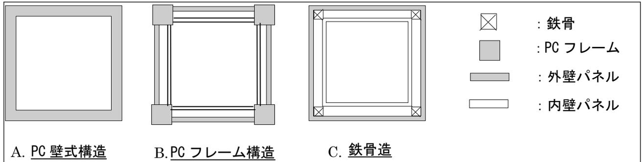
図 4-11 壁式構造と鉄骨造構造
