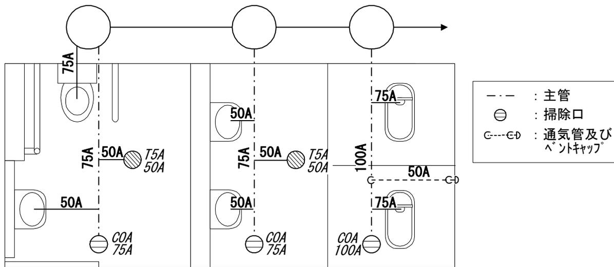
図 4-16 排水管等の管径決定例
