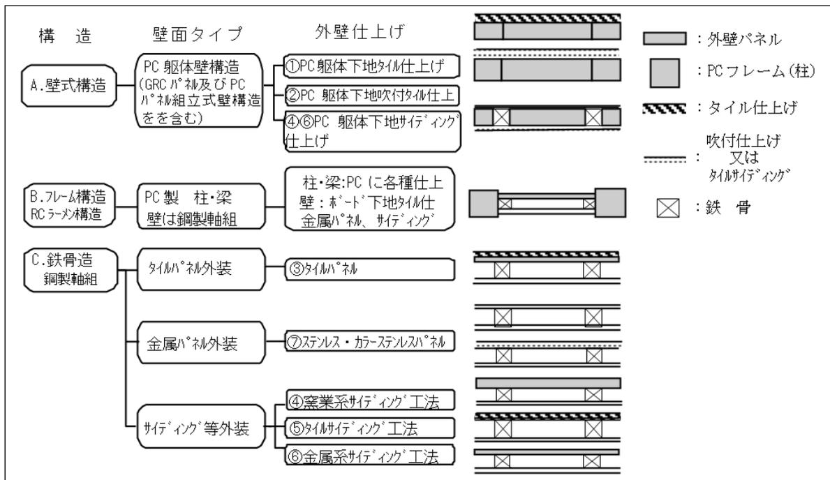
図 4-12 外壁パネルの種類と構造概
