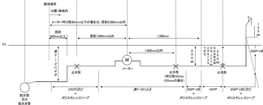
図5-2 配管模式図
