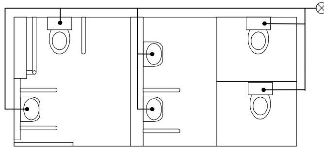
図 4-13-1 床下配管を極力減らした配管例：○
