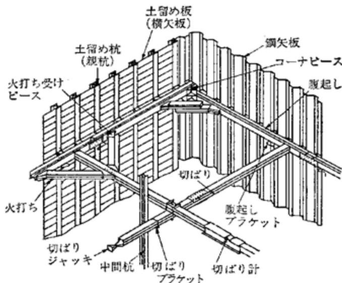
図 9-3 切りばり方式の一般図
