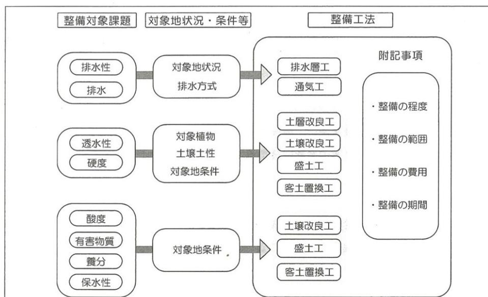
図2-27 基盤計画・設計整備工法選定
