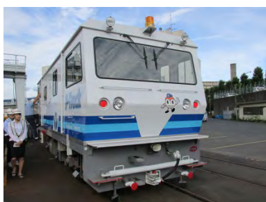
(写真 5) 軌道検測車
