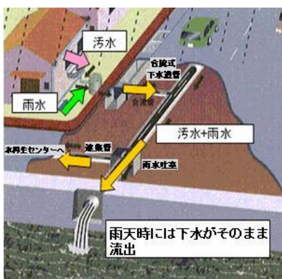
合流式下水道イメージ図
