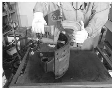
<ライニング張替え作業>
