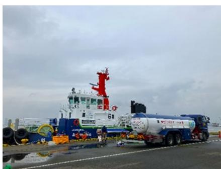
【図7：アンモニア燃料タグボート/Truck to Shipによるバンカリングの様子】
