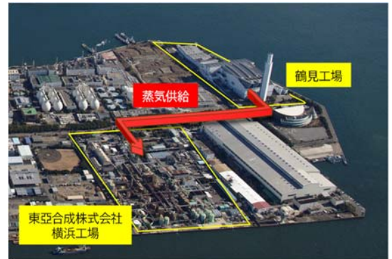
鶴見工場から東亜合成株式会社横浜工場への熱供給イメージ
