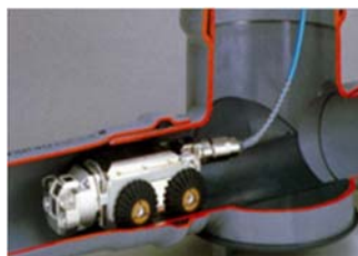
下水道管の TV カメラ調査
