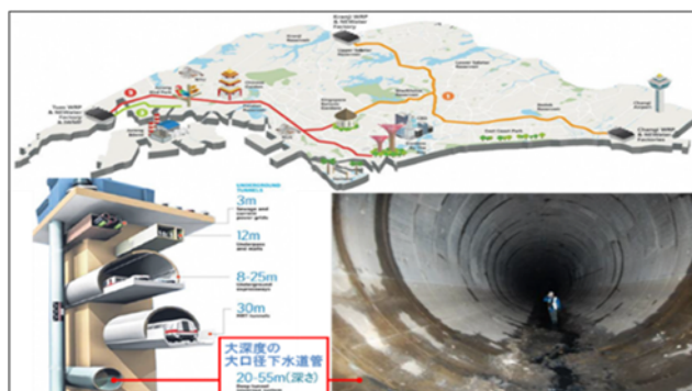
効率的な維持管理手法等の検討が進められているシンガポールの大深度の大口径下水道管
