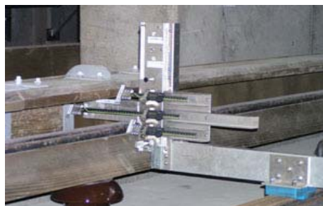
サードレールの測定風景
