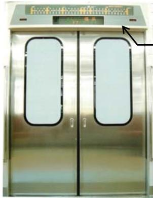
ドア上部に戸閉装置を搭載
