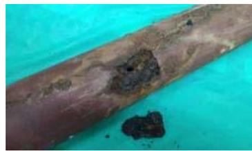
【劣化により埋設配管の損傷部分】
