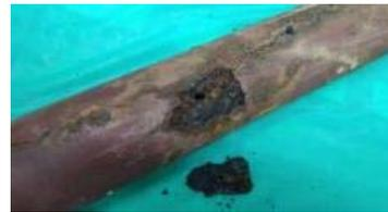
【劣化により埋設配管の損傷部分】
