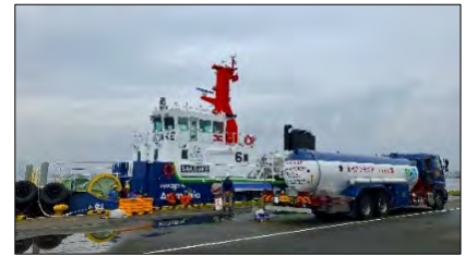
【Truck to Ship アンモニアバンカリング（本牧ふ頭）】
