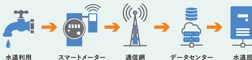
スマートメーターによるデータ通信のイメージ
