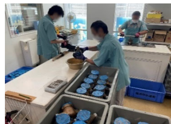
水道メーター分解作業
