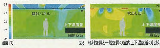
図6 輻射空調と一般空調の室内上下温度差の比較
