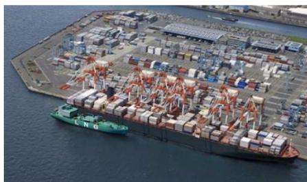
岸壁・棧橋に係留中のLNG燃料船、もしくは錨泊中のLNG燃料船にLNG燃料供給船が接舷（横付け）してLNG燃料を供給する方法。
