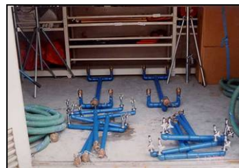
応急給水装置 (配管類)
