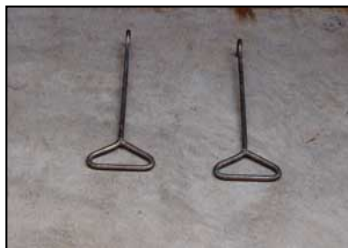
マンホールハンドル
