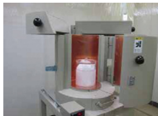
検出器内部に試料をセットした様子
