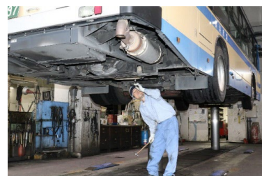
バス車両整備工場の整備用リフト
