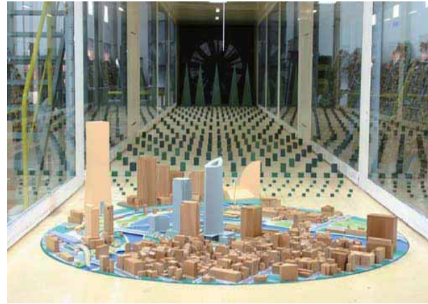
写真 5.10-1 風洞に設置した実験模型の概観
