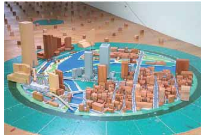
写真 5.10-1 風洞に設置した実験模型の概観
