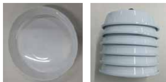
写真 2 自作の自然通風シェード （左）材料：ポリプロピレン製 浅い鉢皿 （右）鉢皿を組み立てて自作したシェード
