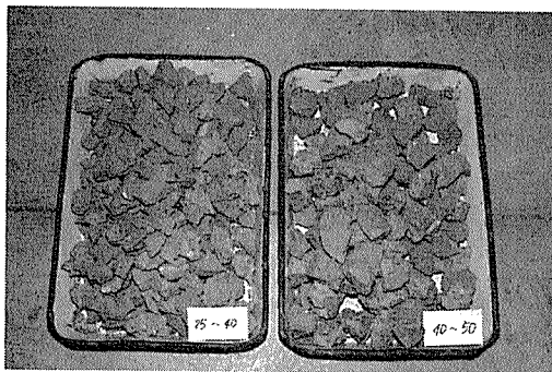
写真-11 ロサンゼルス試験前のF粒度に調整した試料
