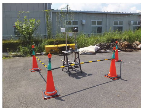
図5 測定器での観測状況 (青葉土木事務所内の通常舗装)
