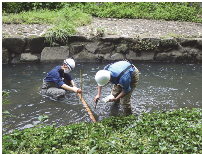
図6 横断方向の水深及び流速測定
