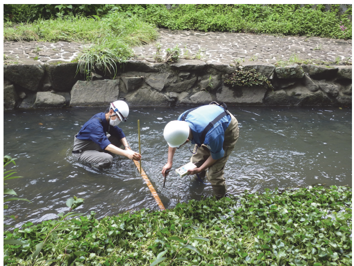
図6 横断方向の水深及び流速測定
