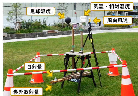
図5 測定機器の外観
