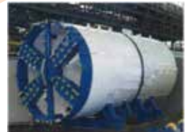
建設のためのシールド機
