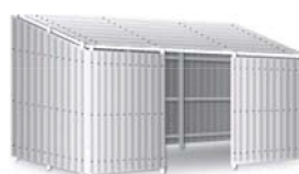
単管パイプ組による屋根掛け
