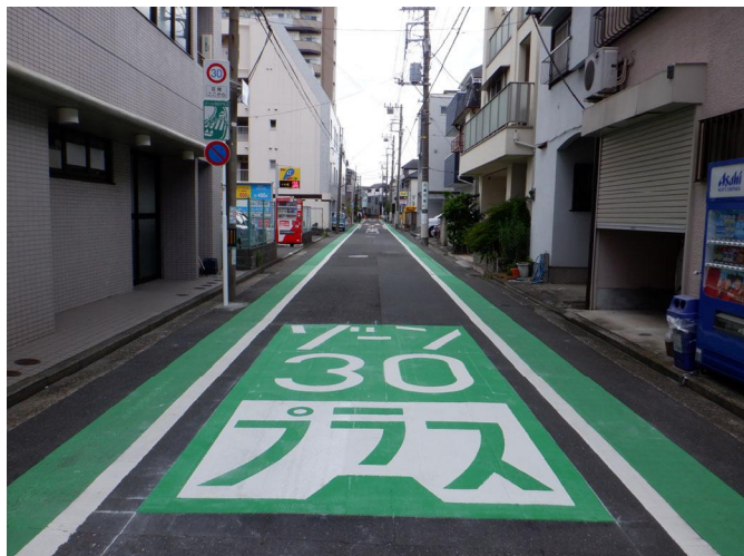
南区「ゾーン30プラス(標識・標示)」設置状況
