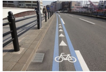
◆自転車レーンに彩度を抑えた色を使用するとともに、 塗装部分を必要最小限に抑えています (西区みなとみらい/国際橋)
