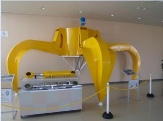
焼却炉にごみを投入するための装置の実物大模型
