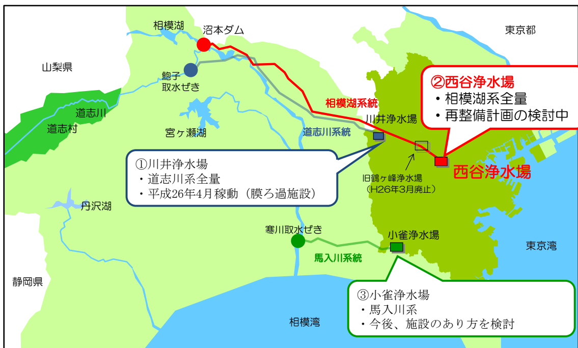
図 4.1.1 浄水場の再構築計画
