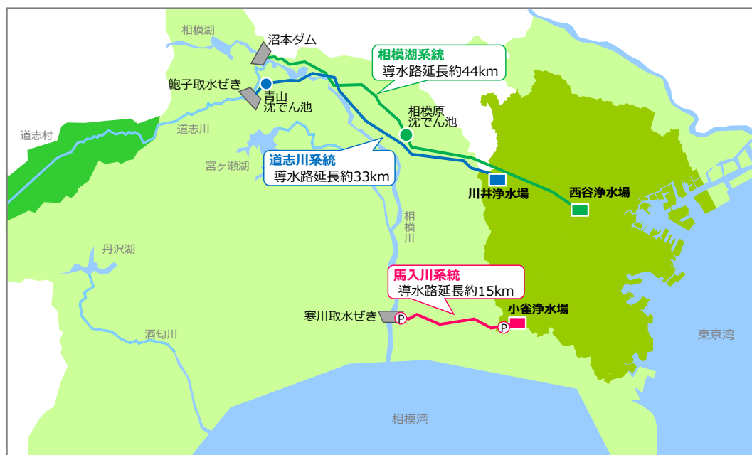
図2-3 本市の取水・導水施設概要図
