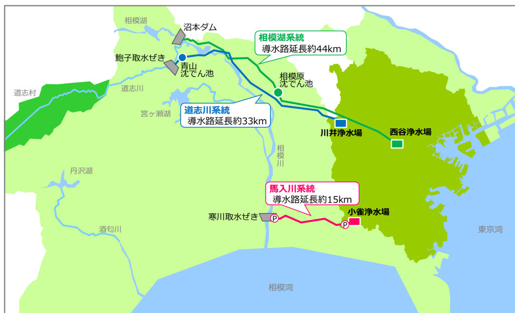
図2-3 本市の取水・導水施設概要図
