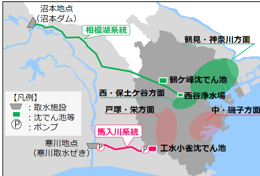
図2-5 工業用水道の施設概要図
