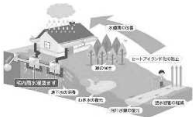
雨水浸透ますの設置
