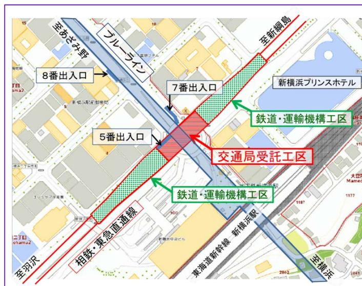
図3 受託工事平面図
