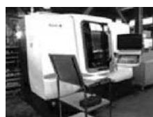
インターネットに接続した工作機械 (左) の稼働状況をモニター (右) により見える化
