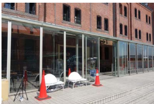
熱線再帰フィルムの実証実験
