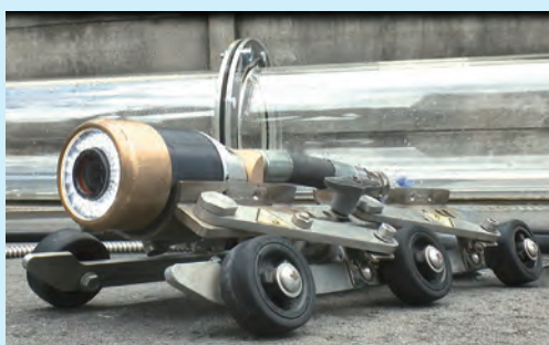
下水道管のスクリーニング調査に使用するノズルカメラ
