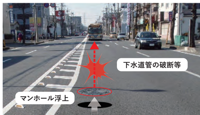
緊急輸送路の下水道管の耐震化
