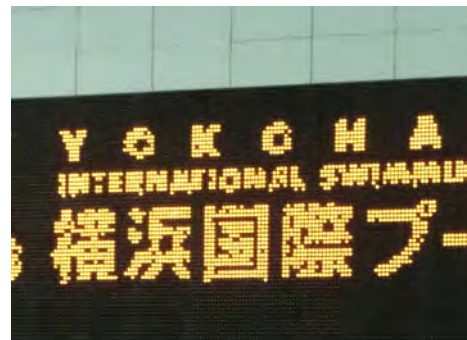
大型ビジョンの球切れの状況
