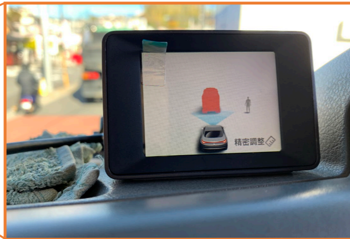
運転席にAI衝突防止装置を搭載しています。歩行者、一般車両が近くにいるときは警報を鳴らして運転手に危険を知らせます。
