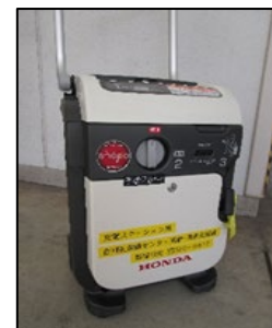
医療用充電ステーション用発電機
